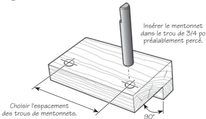
**Figure 1 : Gabarit de perçage pour trou de mentonnets.**
